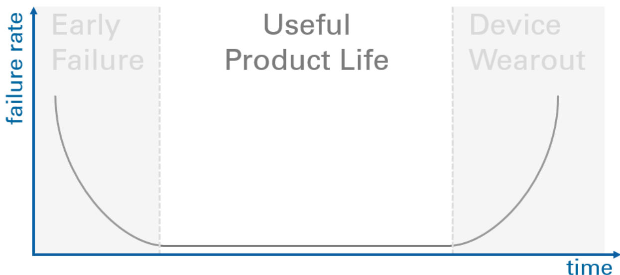
Рисунок 2. Типовая модель надежности устройства (failure rate – интенсивность отказов; Early Failure – ранние отказы; Useful Product Life – срок эксплуатации; Device Wearout – деградация устройства; time – время)
