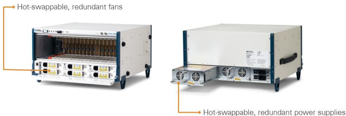
Рисунок 6. Большое время безотказной работы шасси PXI с резервными вентиляторами и источниками питания
